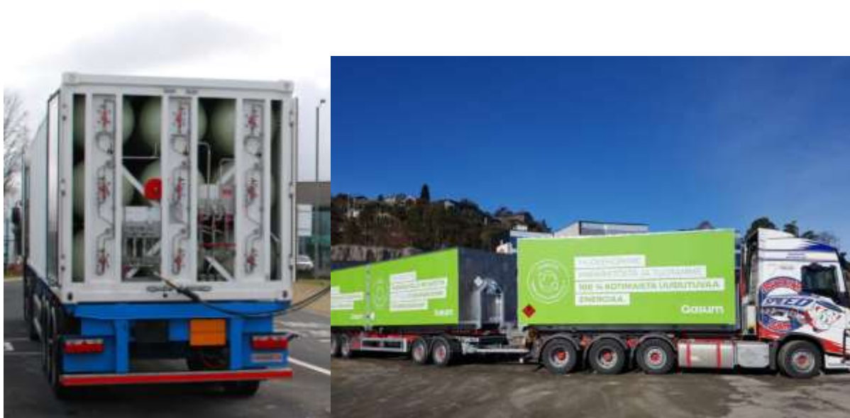
Kuva 5. UMOE Advanced Composites tyyppin IV kaasunsiirtokontti (Biovoima 2019; UMOE 2021).
