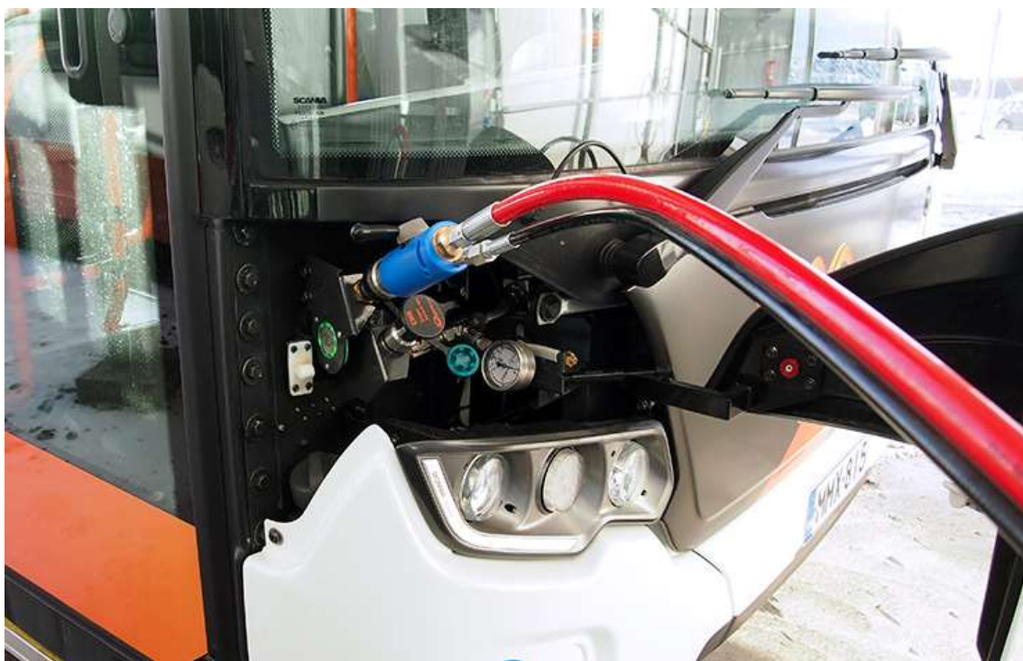
Kuva 2. Polttoainekaasun tankkausliitin kiinnitettynä kaasubussin tankkausjärjestelmään (Scania, 2017a).
