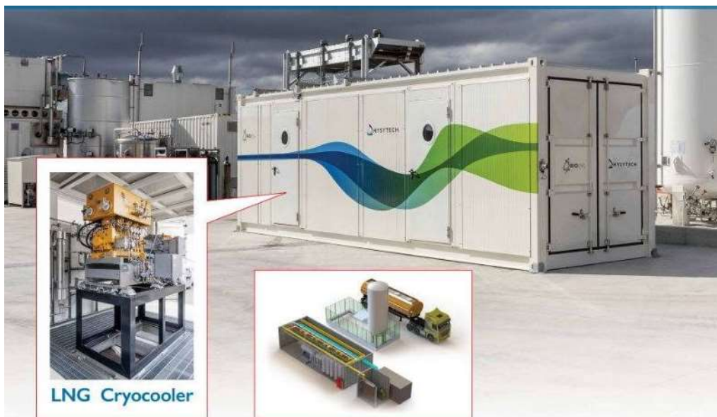
Figure 14. Micro-scale LNG production [Stirling Cryogenics 2019].
